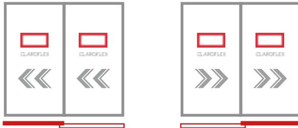
Système avec deux vantaux doté d'une ouverture latérale et d'un déplacement vers la gauche ou vers la droite par les deux voies du rail inférieur.
