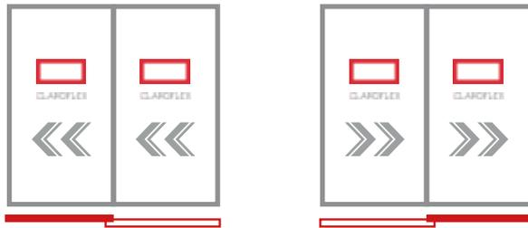
Sistema a due pannelli con apertura laterale e movimento a sinistra o a destra sulle due vie.
